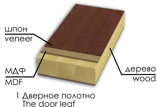
Разрез двери. Конструкция Door cross section. Design
